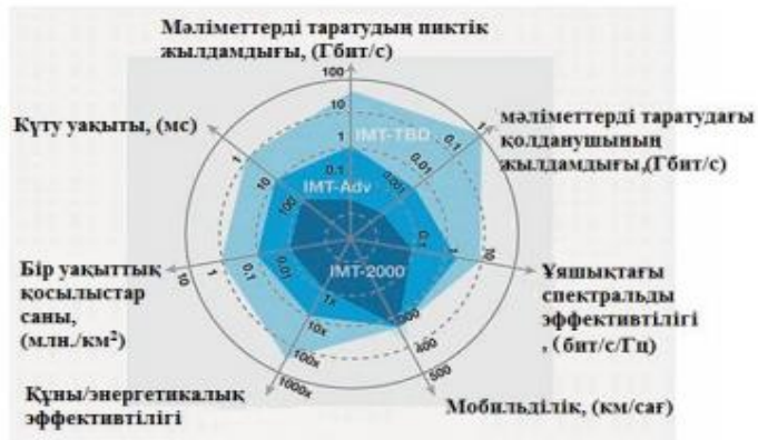
1.3 сурет – 5G (IMT TBD) желісінің қолданыстағы 3G (IMT-2000) және 4G (IMT-Adv) жүйелерімен салыстыруы
